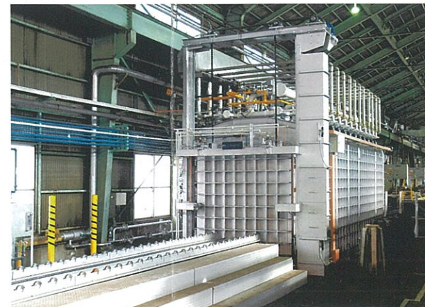
バッチ型無酸化焼鈍炉 Batch-type non-oxidation annealing furnace
